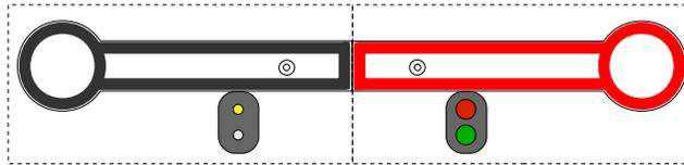
Signallügel für „Halt“ zeigendes Signal
