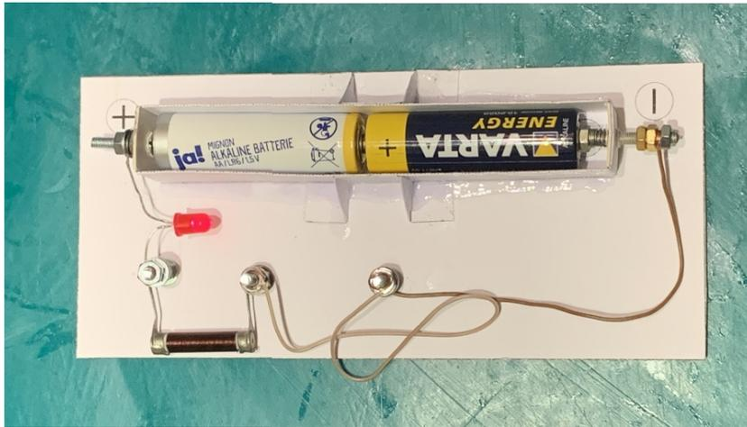
Die Batterien (B) haben eine Spannung von 1,5 Volt. In der hier angewendeten Reihenschaltung sollte eine Spannung von 3 Volt vorhanden sein (Kontakt 1 / 2).
