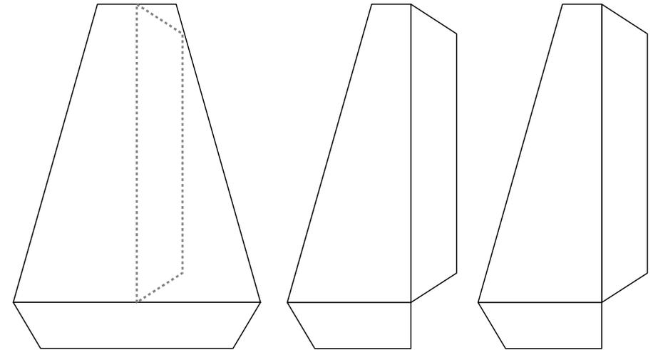
Diese Teile werden auf der Innenseite der Halterung eingeklebt und an den Außenkanten eingeschnitten, damit die Lichterkette befestigt werden kann.
