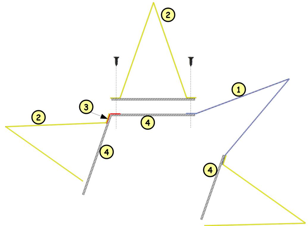
Das Teil 4 (innere Verstärkung) kann erst auf die Rückseite von Teil 2 aufgeklebt werden, wenn alle benachbarten Teile an das Teil 2 angeklebt wurden!
