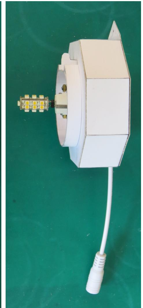
In dieser Ausführung wurden die Anschlüsse nach außen geführt, so dass der Widerstand im Gehäuse verändert oder überbrückt werden kann.
