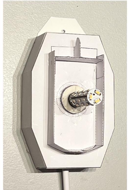
Hier wurde ein Anschlusskabel und eine Sockelhalterung G4 eingebaut.
