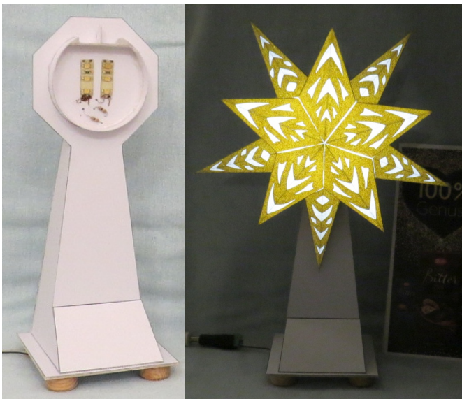
Ständer 998j mit Stern 905n Version 3.4 (zwei LED-Streifen mit Vorwiderstand)
