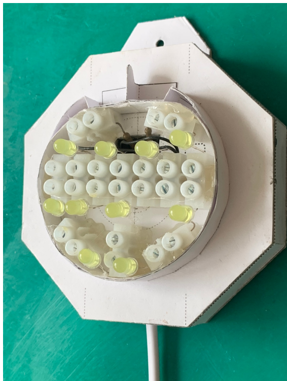
Halterung mit Gehäuse 999c Version 2.0 Hier wurden zehn gelbe LEDs eingebaut.
