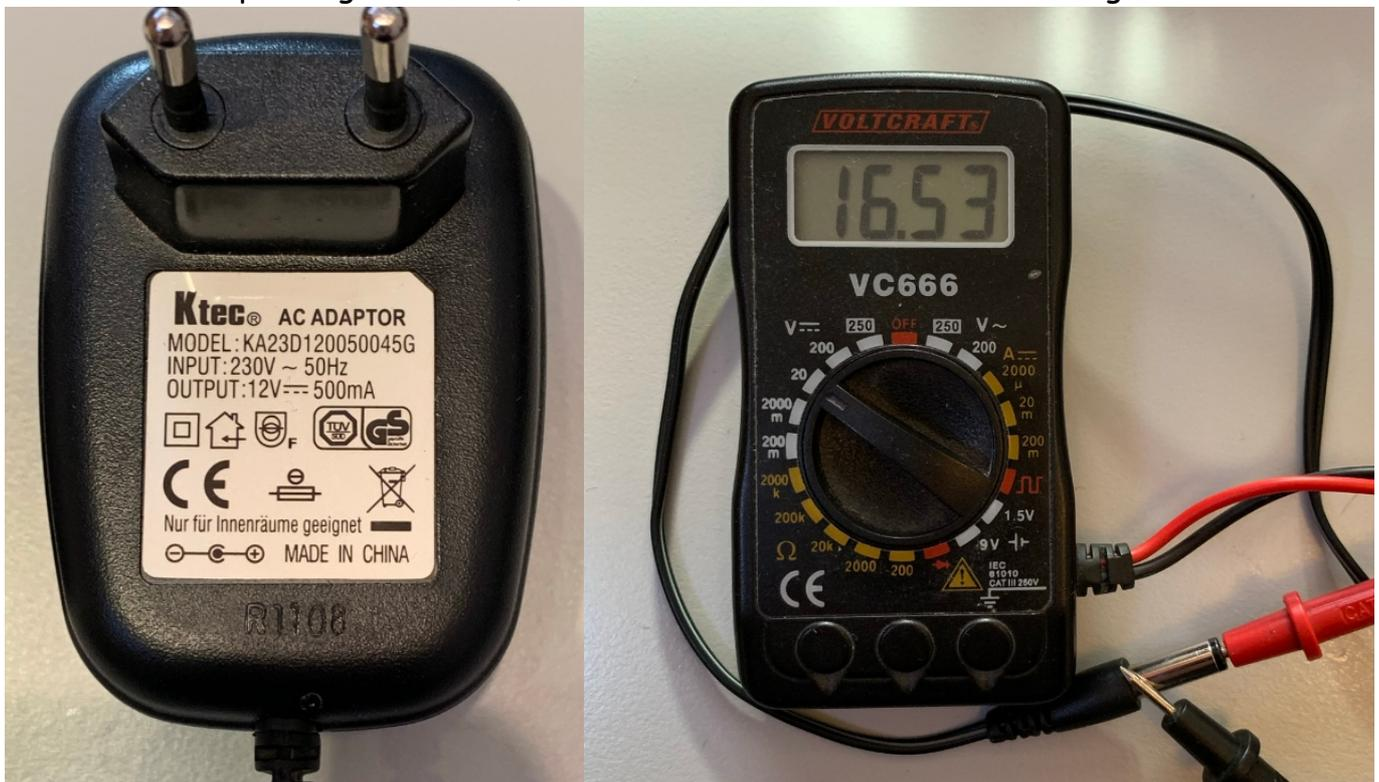
Bild: Dieses Netzteil liefert eine hohe Leerlaufspannung.
