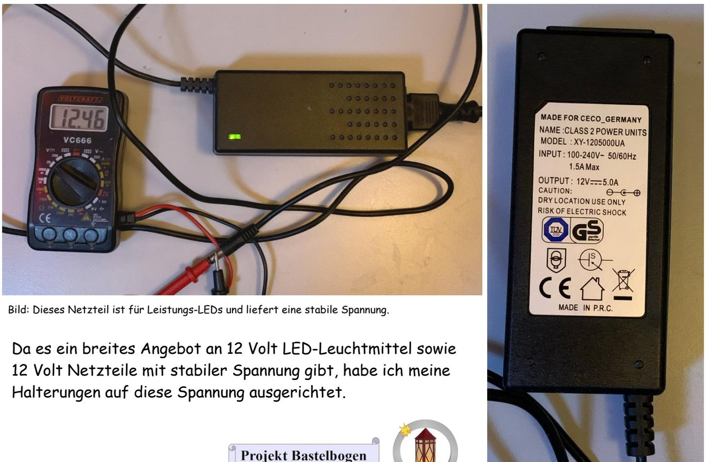
Bild: Dieses Netzteil ist für Leistungs-LEDs und liefert eine stabile Spannung.
